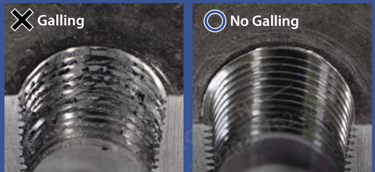
加工 SS400 的照片 Image to process taper pipe thread in SS400 material
